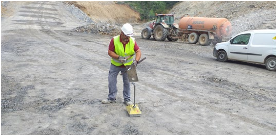
Figura 20. Ensayo "in situ" con equipo radioactivo
