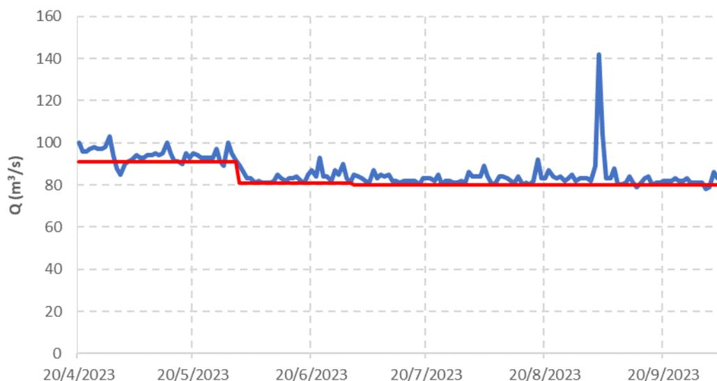
**Figura 19.** Caudales del río Ebro en Tortosa (azul) en 2023 y los caudales ecológicos para ese tramo (rojo).
