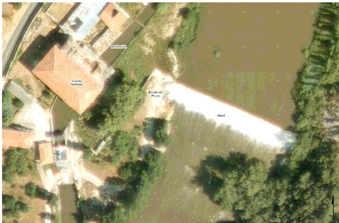
Fig. 6. Vista en planta del azud de derivación
